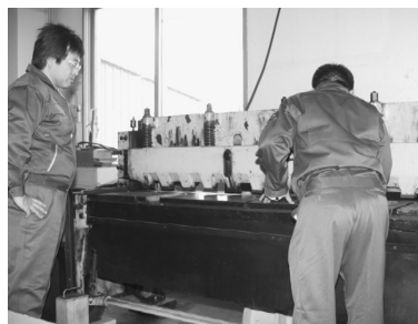
シャーリングマシン 担当教職員立ち会いのもとで使用する
