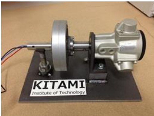
2号発電機 AC 20W (2013.2)
