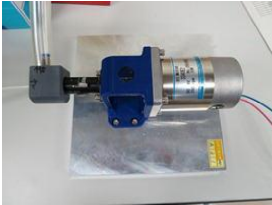
1号発電機 DC 5W (2012.10)
